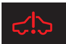
ハイブリッドシステム 異常警告灯
